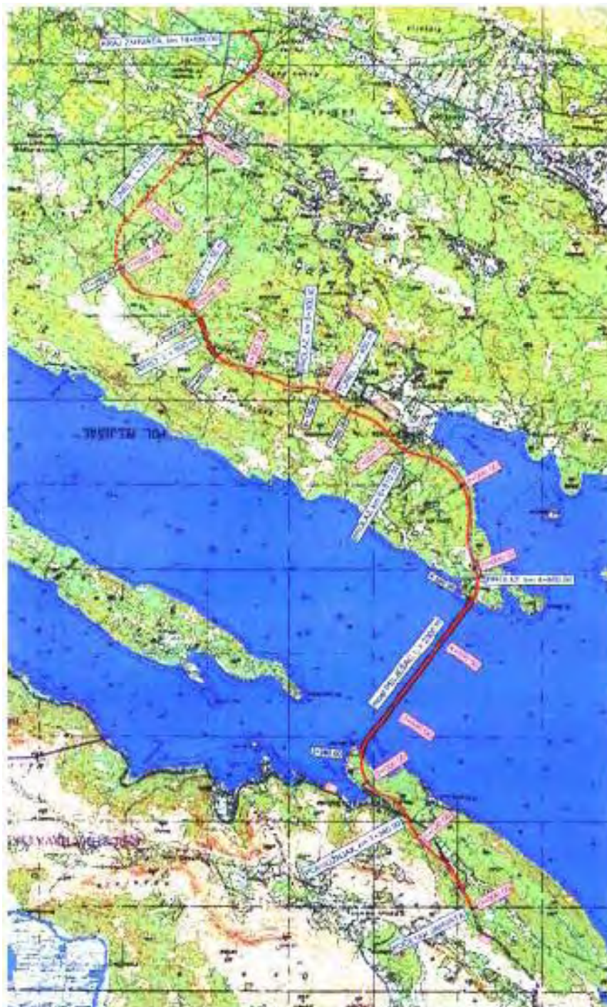
Slika 4.12 Položajni nacrt mosta s pristupnim cestama
